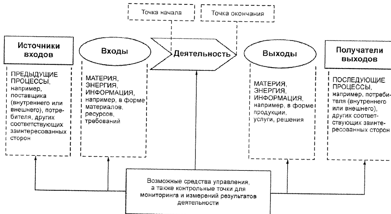
Рисунок 1 — Схематичное изображение элементов процесса
